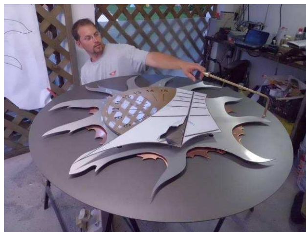
Foto 5 - Lo gnomone in ottone è stato fissato sul piatto tondo d'acciaio.
