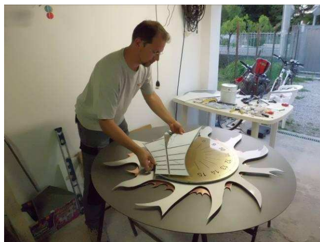
Foto 4 - Si fissa l'ultimo strato in inox della meridiana classica.
