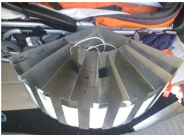
Foto 7 - Sono montati due degl'otto pannelli fotovoltaici all'interno del Ricevitore di luce .
