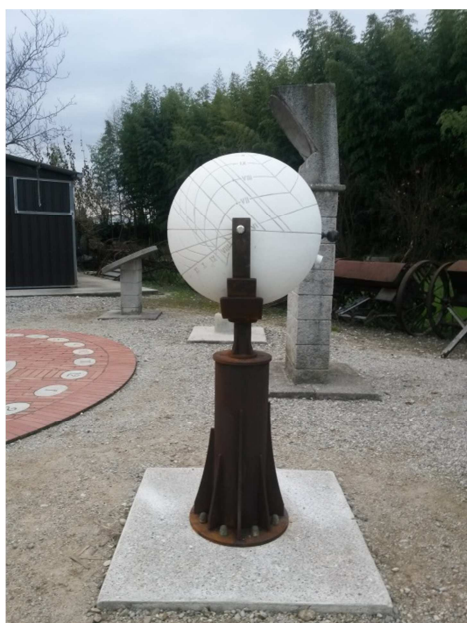
Fig. 12 - Globo posizionato nel cortile delle meridiane di Aiello del Friuli (UD) che simula quello di Prosymna dal diam. di 60 cm (7 cm di diametro più grande dell'originale), pesa 240 kg, il suo asse posa su due supporti per permettere la sua rotazione regolata con due "fine corsa di rotazione" uno per il quadrante n°1 a "spina di pesce" e l'altro fermo per gli altri due.
