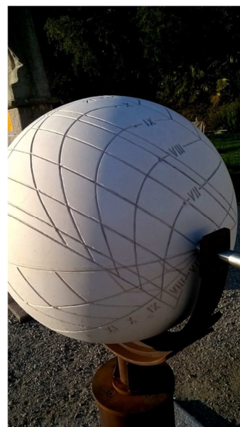
Fig. 13 - Quadrante n.° 2 a linee curve indica la decima ora sul calendario prossimo al solstizio d'inverno (05/12/2016)
